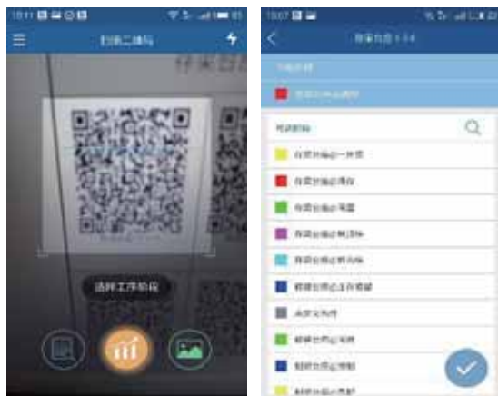
图：手机端扫码记录构件工序状态
