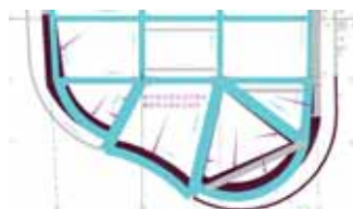
F16-F21层弧形端土建模型对比图 (黑色和蓝色为两对比图)
